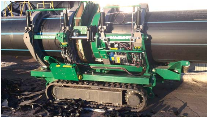
Рисунок 2. Сварочная машина с высоким уровнем механизации
