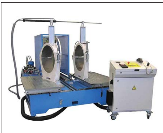
Рисунок 4. Цеховая сварочная машина с ЧПУ
