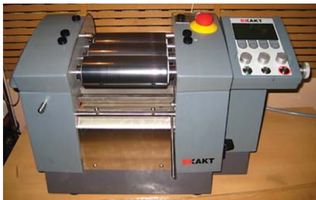
Рисунок 3. Механический трехвалковый диспергатор фирмы Exakt
