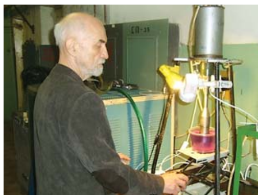
Рисунок 4. Введение нанотрубок в полиэфирную матрицу при помощи ультразвука
