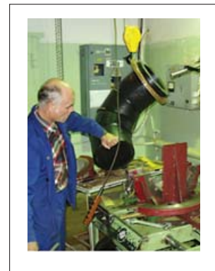
Рисунок 3. Контактная сварка фитингов в трубозаготовительной мастерской
