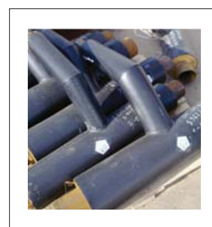
Рисунок 5. Оболочка предизолированного отвода сварена с применением экструзионной сварки
