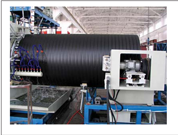
Рисунок 3. Изготовление гофрированных труб навивкой
