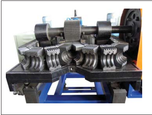
Рисунок 5. Формовочные блоки гофратора
